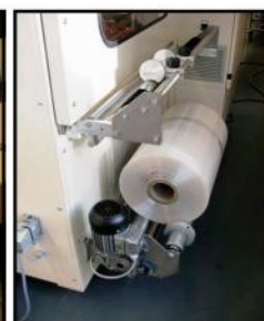
Aangedreven folierolhouder en naald-perforatie t.b.v. ontluchting.
