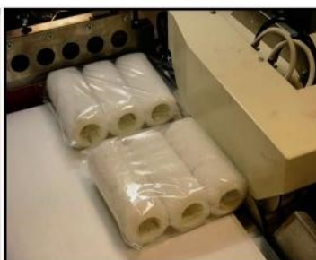
Continue verhit zijlassysteem, synchroon lopend met de uitvoerband. Dit systeem maakt het mogelijk producten van verschillende lengtes door elkaar te verwerken.
