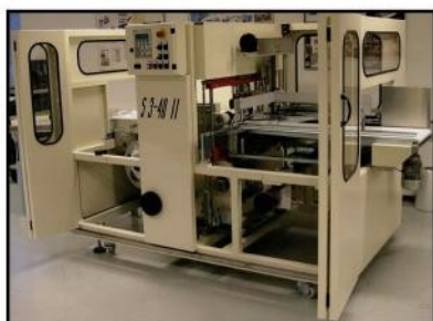
Optimaal toegankelijk d.m.v. beveiligde deuren en scharnierende schakelkast.
