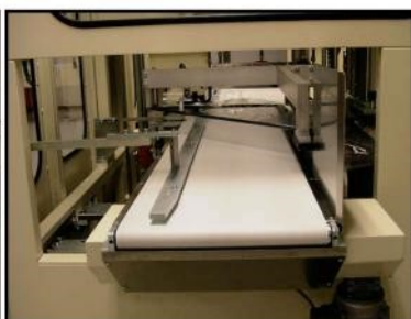
D.m.v. handwiel in de breedte verstelbare invoerband. Bandsnelheden traploos regelbaar d.m.v. frequentieregelaars.
